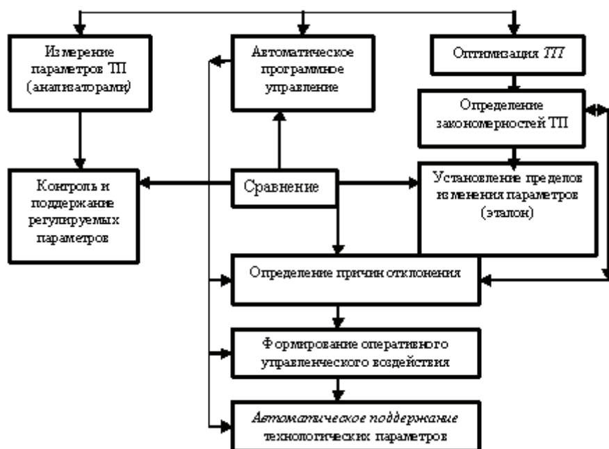
Рис. 8. Блок-схема АСУ технологическим процессом очистки СВ
