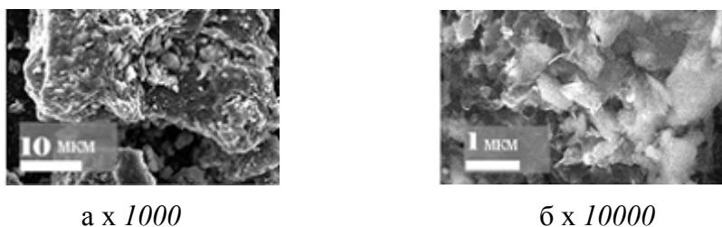
Рис. 2. Микроструктура термически модифицированного при 600 °С дефеката (а) и углерода, отделенного от его поверхности (б)
