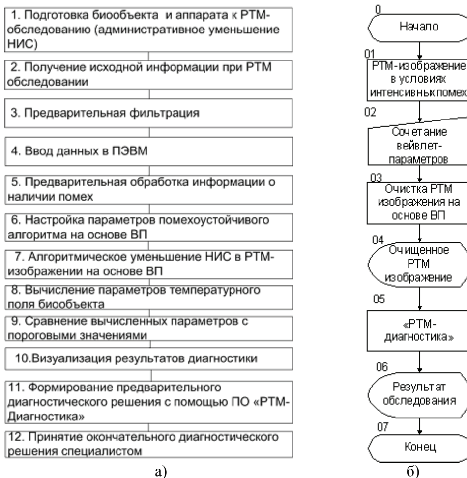
Рисунок 8 – Методика РТМ-обследования в условиях интенсивных помех (а); алгоритм помехоустойчивой обработки РТМ информации (б)
