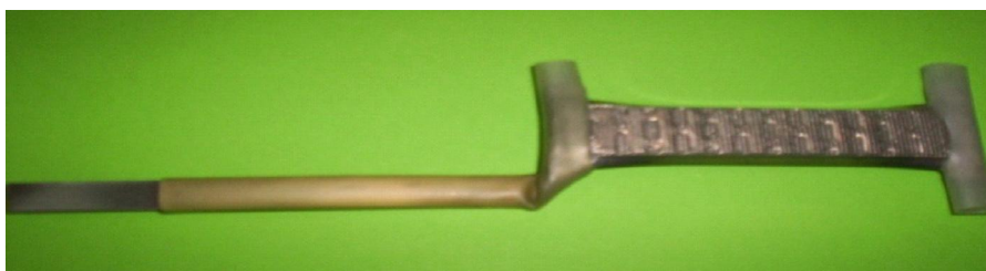
Рисунок 9 – Ламельный электрод на основе Ni(OH)_2 , выделенного из гальваношлама № 2
