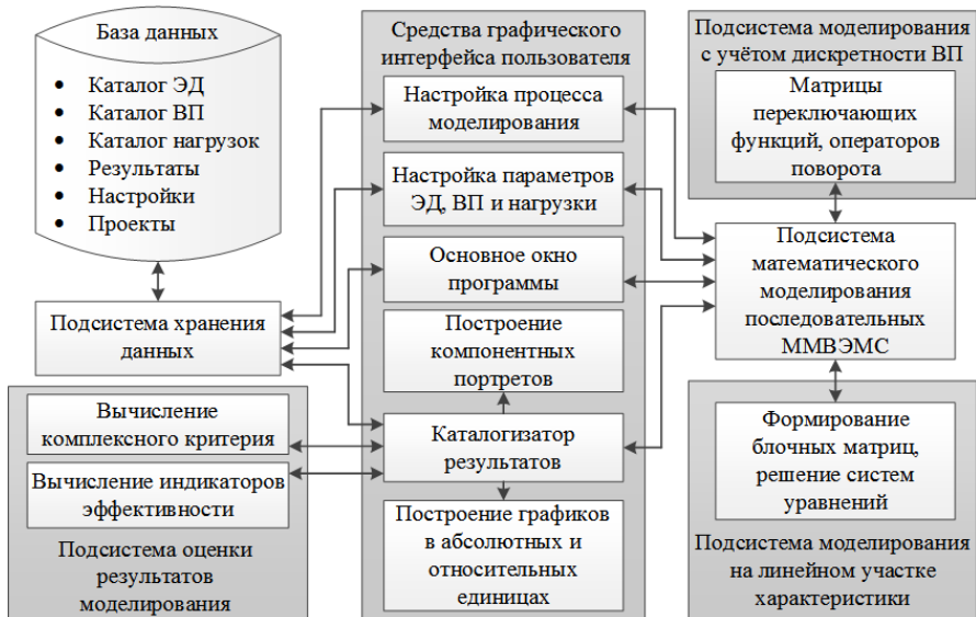
Рисунок 5 – Структура комплекса программ моделирования последовательного многосекционного многосвязного электропривода
