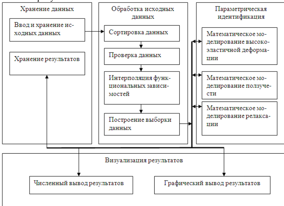
Рисунок 5 – Структура программы «Параметрическая идентификация моделей с производными дробного порядка»
