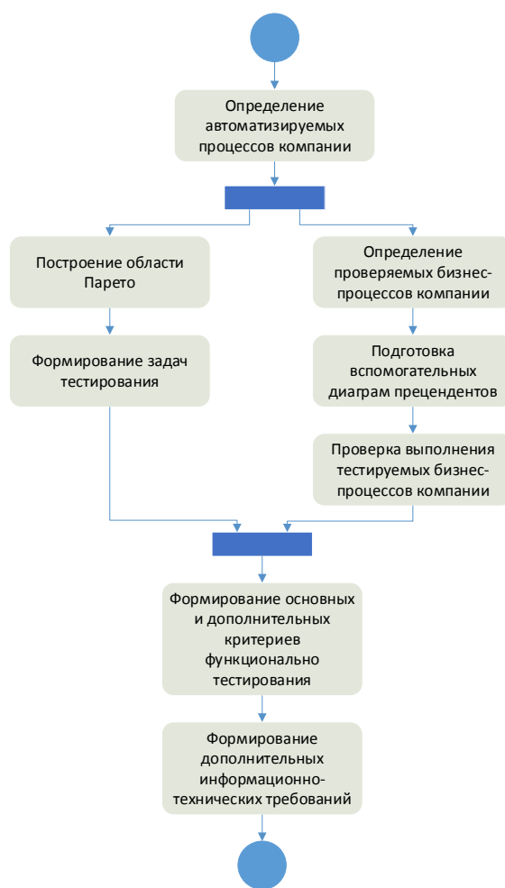
Рисунок 6 – Алгоритмическое представление процесса коррекции методики тестирования
