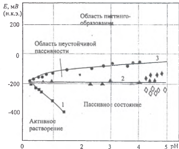
Рис. 1. Диаграмма питтингостойкости стали 12X18H10Т в 3 N растворе NaCl при 343 К: 1 — Фладе-потенциал ( E_F ), 2 — потенциал образования солевой пленки ( E_{сп} ), 3 — потенциал питтингообразования ( E_{по} )
