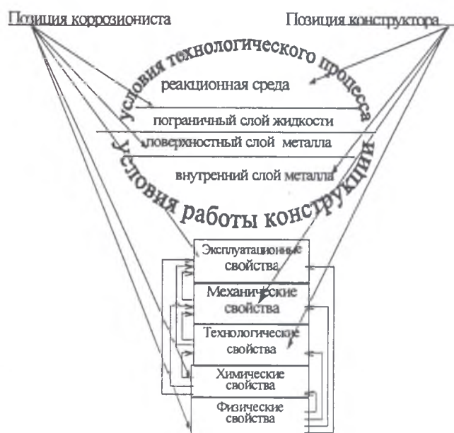
Рис. 1. Подход конструктора и коррозиониста к выбору конструкционных материалов
