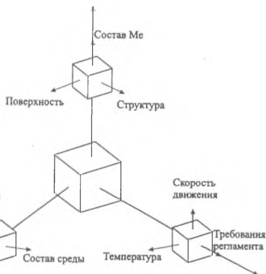
Рис. 2. Коррозионная стойкость как динамическая характеристика материала [5]
