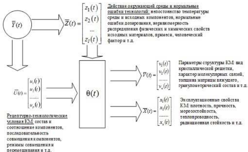
Рис. 1. Структурная схема объекта управления – КМ
